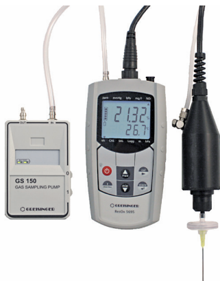
Restsauerstoff-Messung mit dem ResOx
